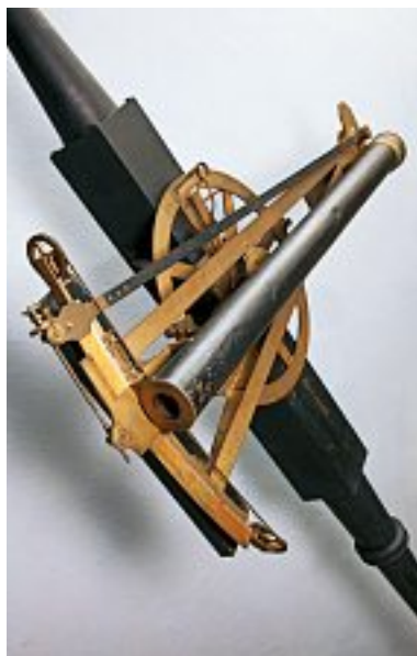
Il Settore equatoriale Sisson (dal nome del costruttore), strumento scientifico per il calcolo astronomico
